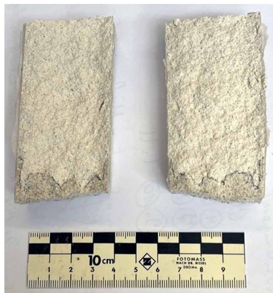
Abb. 15: Eindringtiefe bzw. Saughöhe des Wassers (mit Bleistift nachgezeichnet), Prismen unmittelbar nach Beendigung der Saugversuche gespalten; links: saugender mineralischer Putz, rechts: wasserabweisender Armierungsputz
