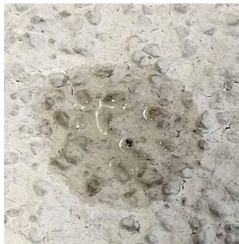
Abb. 16: Benetzungsprobe an einem wasserabweisenden Strukturputz nach 5 min (oben) und 15 min (rechts)
