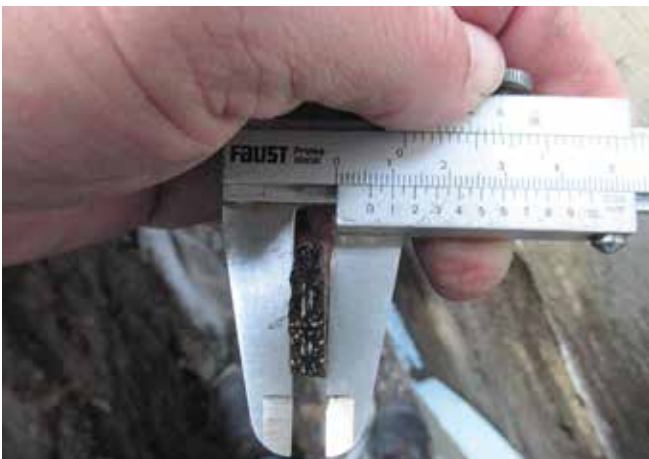
Abb. 40: Differenzdickenmessung an einer vom Bauwerk abgelösten Probe der Abdichtungsschicht mit einem handelsüblichen Messschieber
