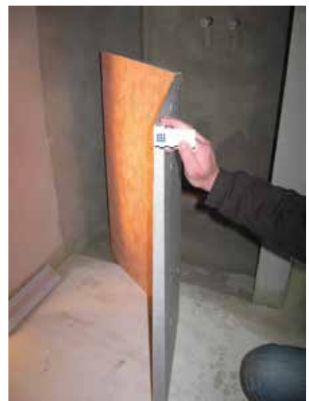
Abb. 53: Produktbeispiel einer AIV-P mit werkseitig aufgebrachtener bahnenförmiger Abdichtung für eine bodengleiche Dusche
