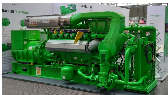
Abb. 24: Große Zukunft für Generatoren mit Gasmotoren (Exponat auf der Hannover Messe 2019): Heute Erdgas, dann Biogas, später vielleicht Wasserstoff – die Umstellung ist eine relative Kleinigkeit, und die Kraft-Wärme-Kopplung ist immer gleich im System enthalten
